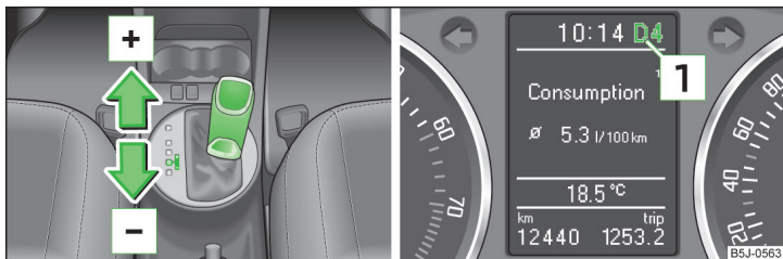
Илл. 111 Селектор/дисплей MAXI DOT: включённая передача
